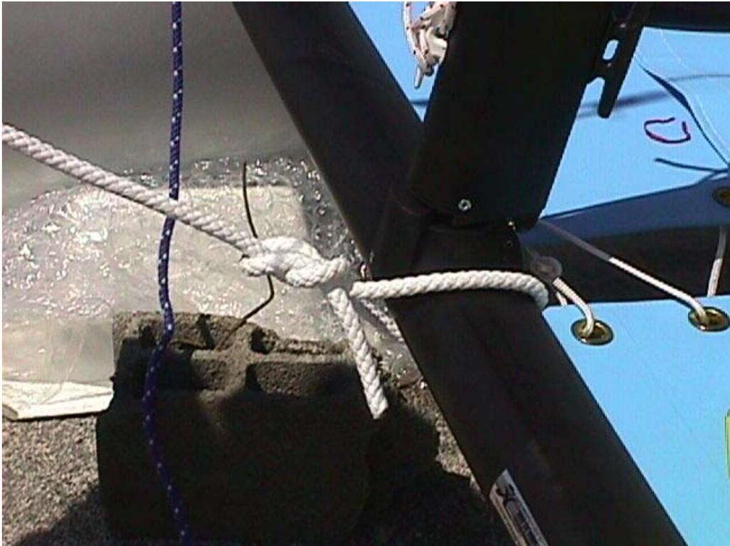
Prendre le bout de redressement dans le sac de cordage et l'attacher comme indiqué sur la photo. Ranger l'extrémité du cordage dans la poche de trampoline.
